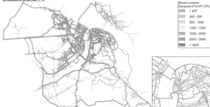
Рисунок 2.13 - Картограмма интенсивности движения автотранспорта в час пик на улично-дорожной сети г. Нижнего Новгорода
