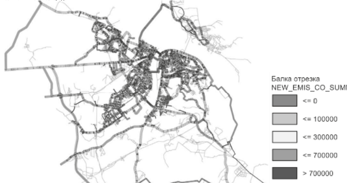
Рисунок 2.14 - Картограмма суточных вредных выбросов автотранспорта (CO) в атмосферу на улично-дорожной сети г. Нижнего Новгорода
