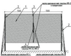
1 – плёнка полиэтиленовая, толщиной 350 мк; 2 – металлическая пластина МП-1; 3 – металлическая пластина МП-3; 4 – болт М8х40 мм с гайкой и 2-мя шайбами.
