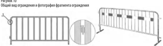
Узел 1 – соединение секций ограждения.
