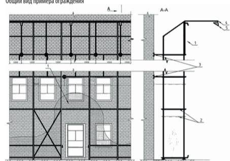
1 – полотно ограждения; 2 – леса; 3 – крепление лесов к зданию; 4 – кронштейн со светильником, шаг установки 3 м; 5 – прожектор наружного освещения.
