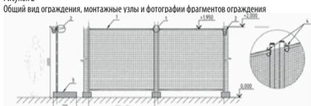
1 – панель рамы; 2 – сигнальный фонарь; 3 – опорный бетонный блок; 4 – кабельная стяжка; 5 – кронштейн настенный; 6 – лоток проволочный.
