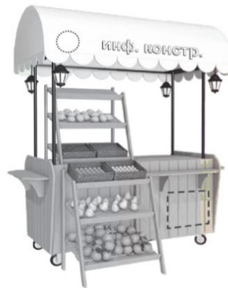
Рекомендуемые габаритные размеры: 1500 x 1000 x 2000 (h) Конструкция – металл
